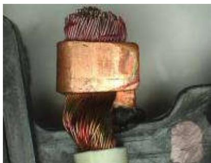
固定端子的热压焊
