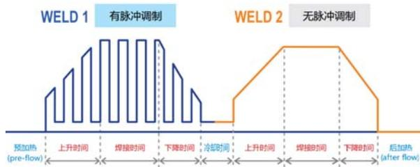
WELD1、WELD2均可分别设置缓升时间/缓降时间/焊接时间以及脉冲调制的有无。
