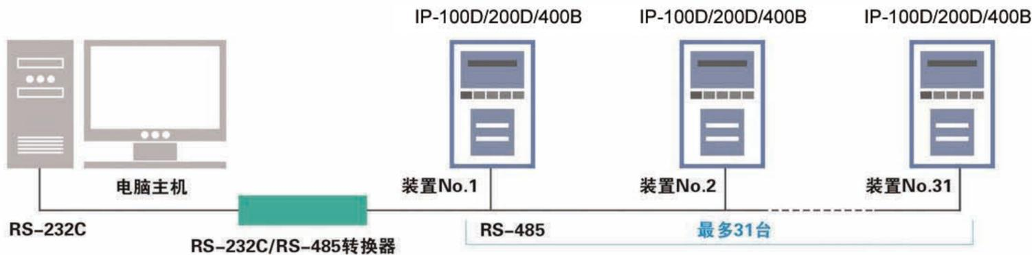
连接到外部的电脑上，能够读出焊接条件，显示监测器的数据及错误代码。
